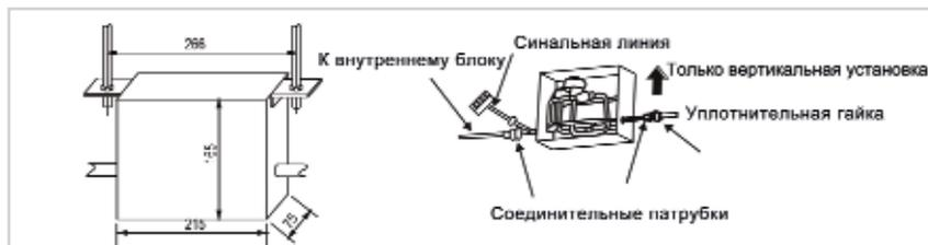
Установка электронного расширительного вентиля
