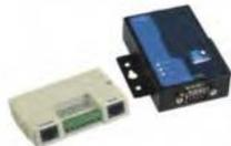
Опция является преобразователем внутреннего протокола контроллера в протокол TCP/IP, используемый для передачи данных через интернет.
