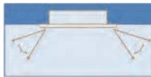
Угол поворота первой створки жалюзи составляет 40-42°, второй створки - 37-38°. Такая конструкция обеспечивает наиболее равномерное распределение воздушного потока по помещению.
