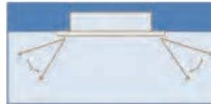
Угол поворота первой створки жалюзи составляет 40-42°C, второй створки - 37-38°C. Такая конструкция обеспечивает наиболее равномерное распределение воздушного потока по помещению.
